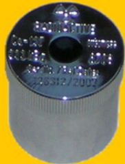
Prüfstrahler im Strahlertopf
