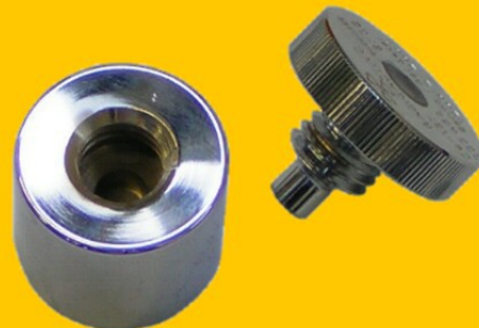
Prüfstrahler aus Strahlertopf herausgeschraubt
