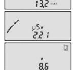
Anzeige der Dosis digital sowie analog als Bruchteil der Warnschwelle auf einer gedachten Skala von 0 bis 100%.
