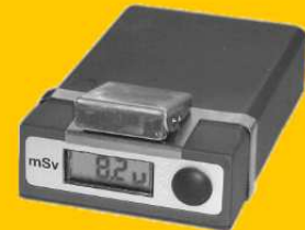
Anzeige der Batterie- spannung im Standby- Zustand »Batterie«
